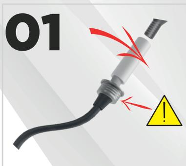
Fixe a cabeça superior da bomba de suspensões à válvula do amortecedor, certificando-se de que a parte inferior da cabeça da bomba se mantém na posição inferior. Não aparafuse para cima as duas em conjunto.
