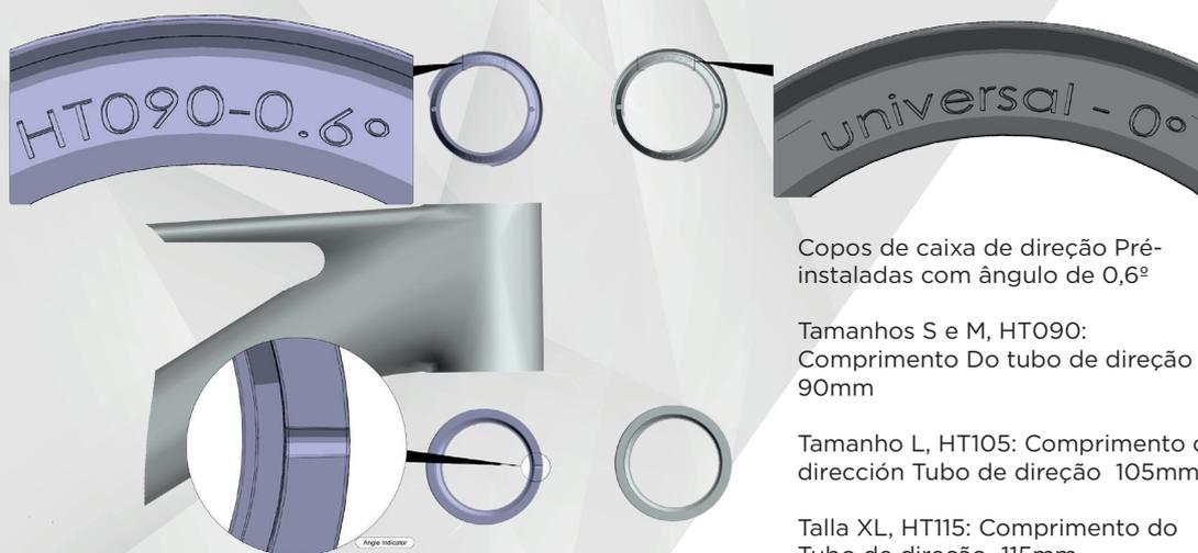
Os copos de 0,6° podem ser instalados na posição + ou - mas é essencial que os marcadores de indicação de ângulo na caixa de direção sejam colocados de forma oposta uns aos outros, o de cima virado para a frente e o de baixo virado para trás (ou vice-versa).
