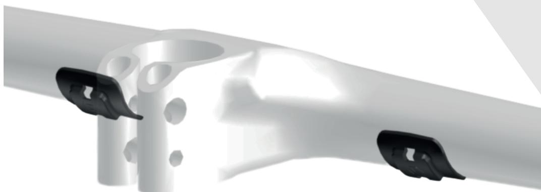
Tenha em atenção que o comprimento máximo do parafuso para a grade de bidon no tubo do selim é de 10mm. Os rebites roscados têm extremidades fechadas, e a utilização de um parafuso mais longo pode resultar em danos no quadro.
